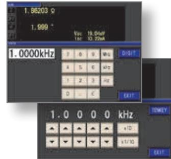
频率的设置 (小键盘输入和上下输入)
