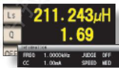
L,Q显示界面(1kHz, CC1mA测量)
