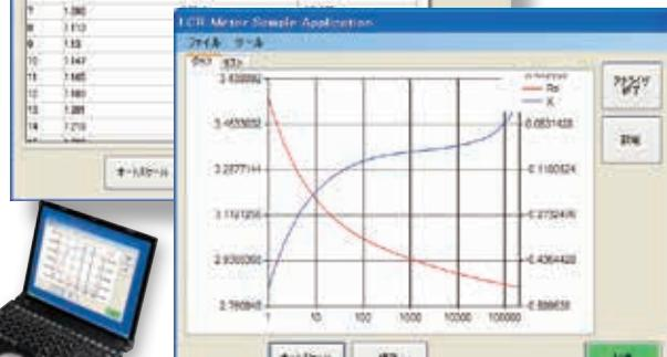
LCR标配软件所显示的扫频测量结果的明细图表界面
