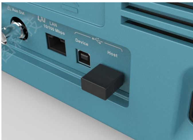
Wi-Fi 转接头通过集成设置菜单配置，支持无缝通信。
