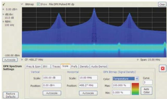
图9. DPX 频谱显示及DPX位图(信号密度), 其中采用默认颜色曲线设置。
