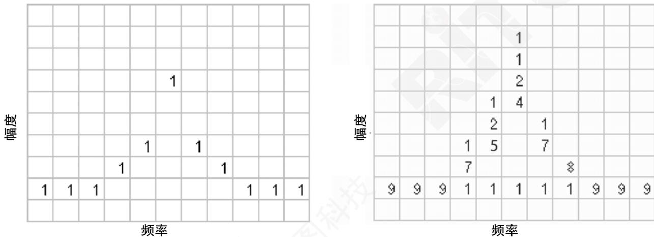
图 6. 更新 1 次(左)和 9 次(右)的三维位图数据库实例。注意每一栏包含同样的“命中”总数。
