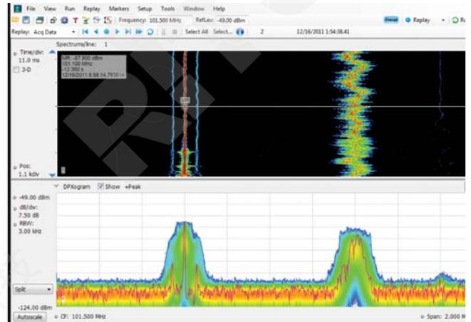
图 21. 没有压缩的 DPX 频谱图画面，可以用来进行详细分析。
