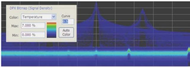
图 13. 把值调节到小于 1，会降低使用“温度”调色板查看偶发的随时间变化的事件的对比度。
