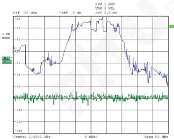
图 3. 扫频分析仪上的 Max Hold 和 Normal 轨迹，这两种轨迹都使用 +Peak 检测技术。Max Hold 轨迹显示了笔记本电脑上较强的信号，但这两个轨迹都没有接入点传输。
