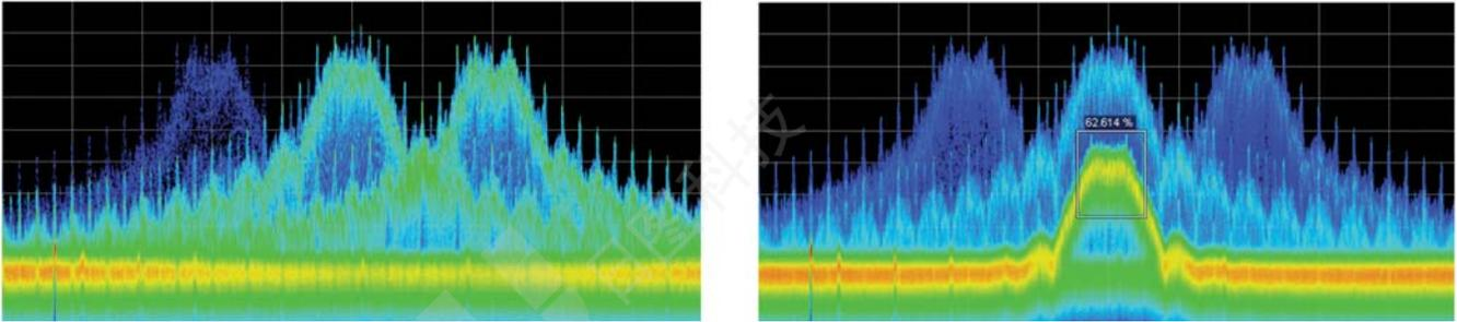
图 37. Density Trigger 功能实例。左：自由运行的 DPX 频谱画面，显示变化频率的脉冲。中间的短脉冲偶尔会出现一下，但仅使用 Run/Stop 按钮很难捕获。右：触发的 DPX 画面显示了在没有触发的画面中不明显的低幅度脉冲。分析仪设置在用户画的框中测得的平均密度大于等于 50% 时触发采集。
