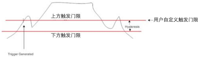
图 41. 对频率边沿触发使用粘滞值，减少来自噪声信号的假触发数量。由用户自定义触发电平开始，从用户自定义触发电平中减去粘滞值。信号必须同时通过触发电平和粘滞值电平，触发才会发生。
