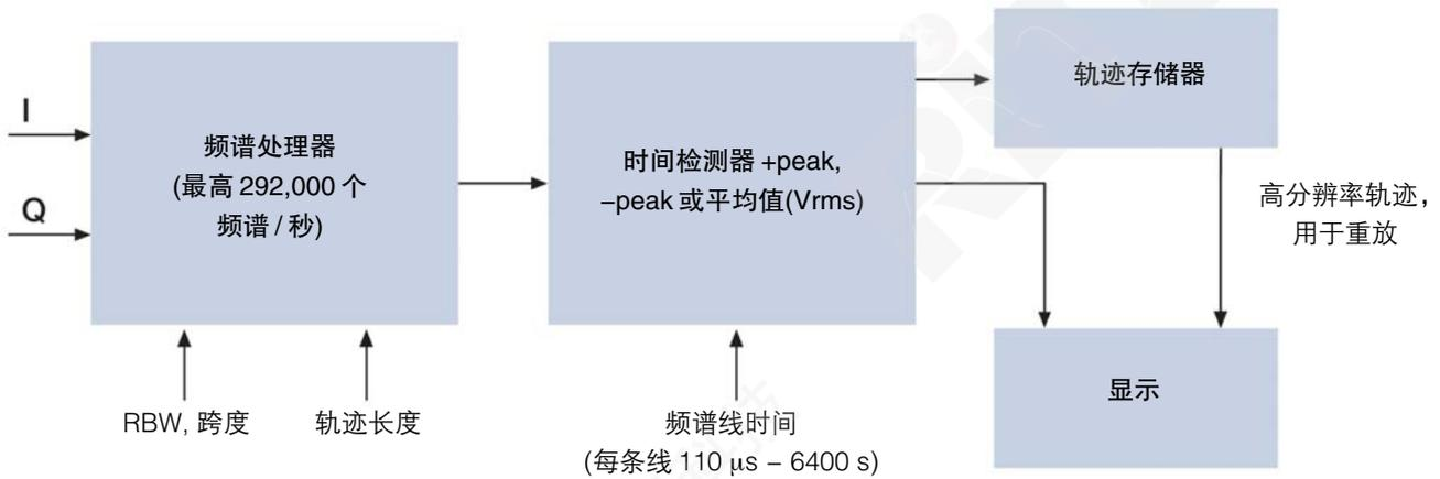
图 19. DPX 频谱图处理方框图。
