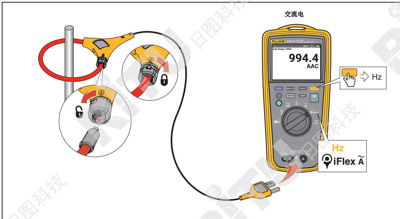
图示 10. 交流电流测量
