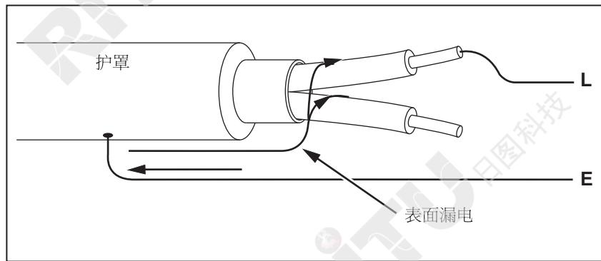
图 1. 表面漏电
