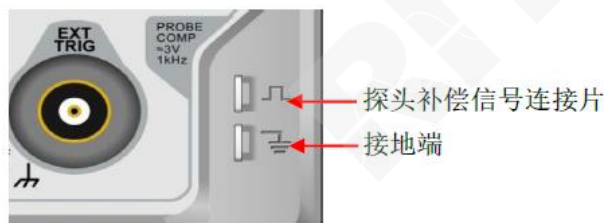
图 1 探头补偿信号连接片和接地端
