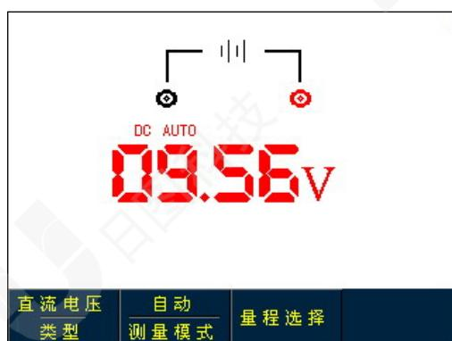
图5-5 直流电压测量
