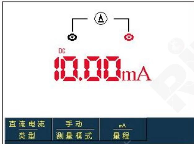
图5-8 小于400mA直流电流测量
