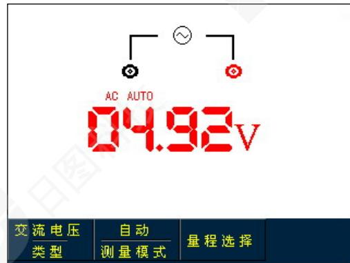
图5-6 交流电压测量
