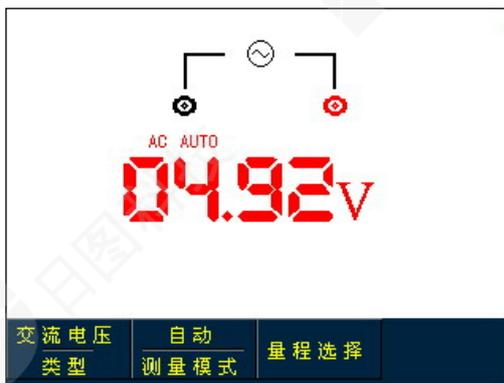
图5-6 交流电压测量
