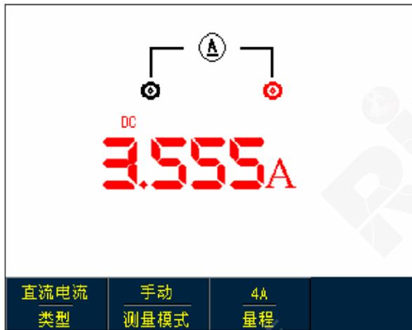
图5-16 大于400mA直流电流测量
