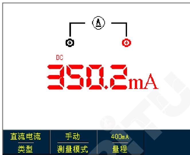
图5-15 测量40mA~400mA的直流电流
