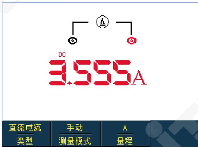
图5-9 大于400mA直流电流测量
