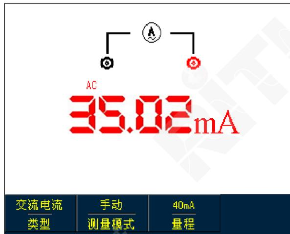
图5-18 小于40mA交流电流测量
