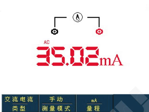
图 5-11 小于 400mA 交流电流测量
