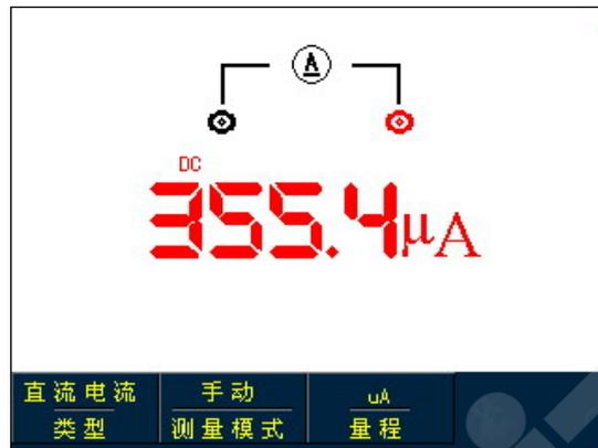
图5-13 小于等于1mA直流电流测量
