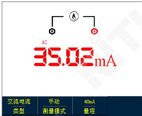
图5-18 小于40mA交流电流测量
