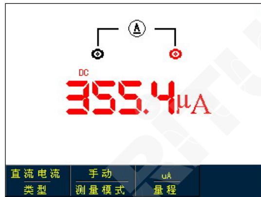
图 5-7 小于 4mA 直流电流测量
