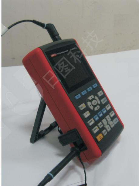
图3-2 本机补偿信号连接
