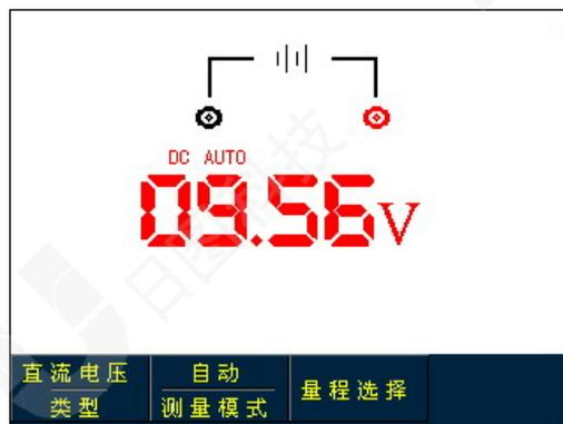
图5-5 直流电压测量
