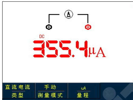
图5-13 小于等于1mA直流电流测量
