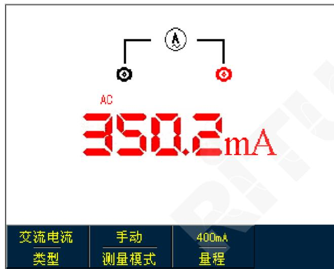
图5-19 测量40mA-400mA的交流流电流
