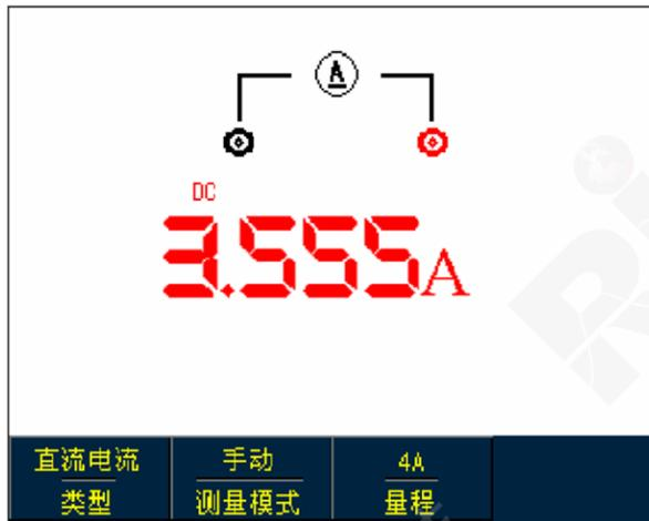
图5-16 大于400mA直流电流测量
