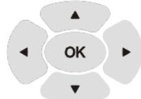
**OK** 及 **▲**、**▼**、**◀**、**▶**键：方向键及OK键，在一般情况下用于隐藏/显示当前菜单栏；在万用表(DMM)方式下，进行A档电流测量时，用于确认电流分流器是否正确连接。
