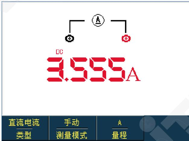
图5-9 大于400mA直流电流测量
