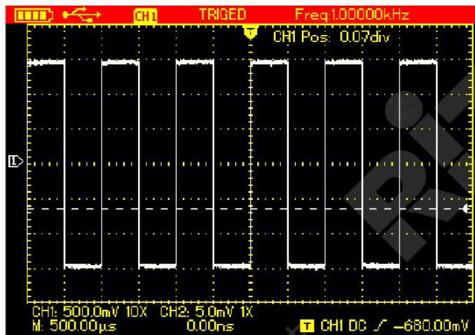
图4-8 调节触发电平
