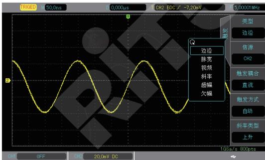
4 两通道时基独立可调，同时有效触发两通道相差1000倍以上的信号
