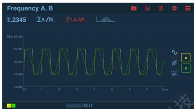
在屏幕上，一个或两个通道上查看快速 FM 或任何时间/相位/频率调制。在这里，我们看到具有正弦波和方波形状的FM调制
